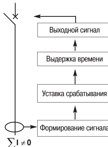
Рис. 16. Функциональная схема работы УЗО
