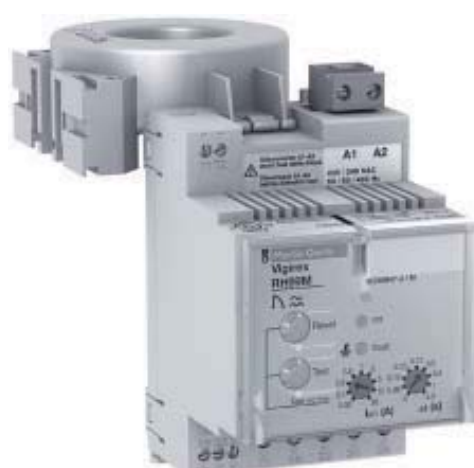
Рис. 11: через средство тора ток замыкания передает энергию сигнала электромагниту, якорь которого удерживается в притянутом состоянии с помощью постоянного магнита. Когда порог срабатывания достигнут, электромагнит нейтрализует силу притяжения постоянного магнита, якорь под действием пружины отходит от сердечника, приводит в движение контакты – выключатель отключается.
