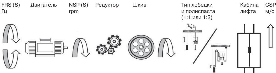
Для определения момента инерции и настроек контура скорости необходимо знать номинальную скорость лифта (CSP) и его грузоподъемность (LCA).
