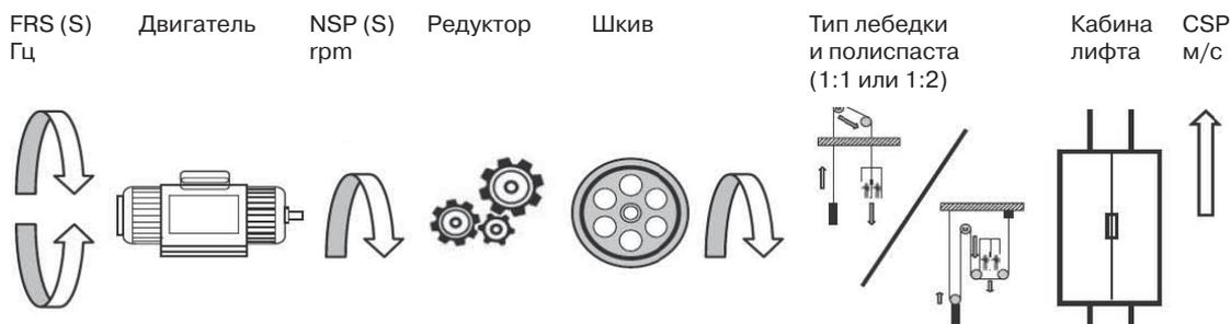
Для определения момента инерции и настроек контура скорости необходимо знать номинальную скорость лифта (CSP) и его грузоподъемность (LCA).
