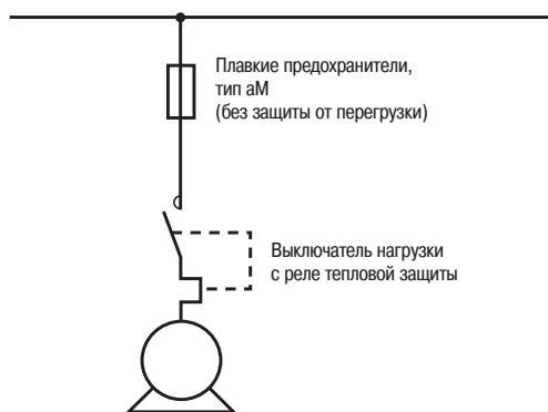
Рис. G40: Цепь защищена плавкими предохранителями aM
