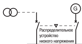
Рис. D16 : Подсоединение резервного генератора
