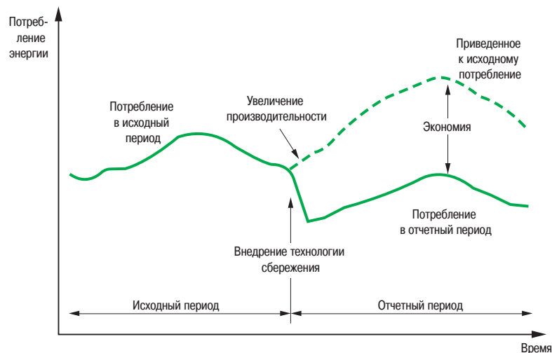
Рис. К31. Принцип определения исходного периода
