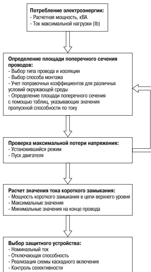
Рис. G1: Логическая схема для выбора сечения кабеля и защитного устройства для заданной цепи
