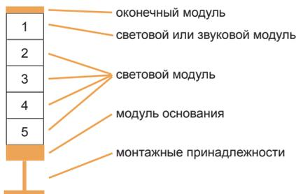
**BR 50 Модуль основания и оконечный модуль для сигнальных колонн**
