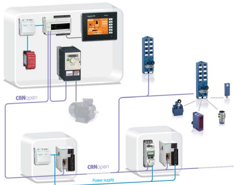
Пример островов с использованием Modicon OTB на шине CANopen
