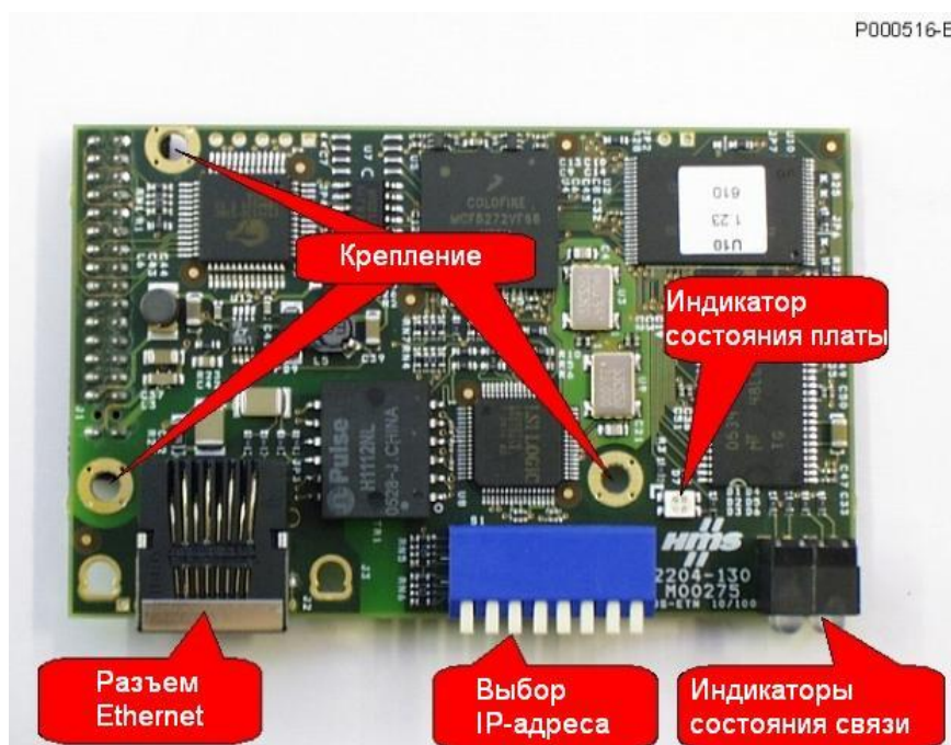
Рис. 133: Плата связи Ethernet
