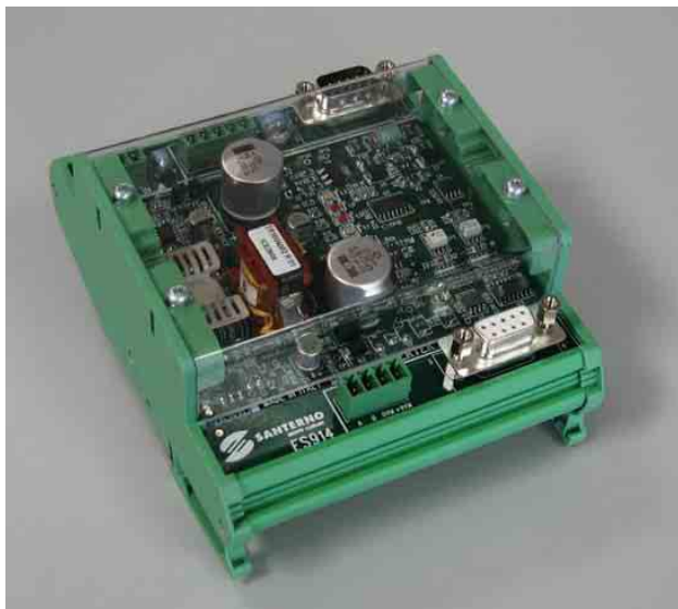
Рис. 170: Плата источника питания ES914
