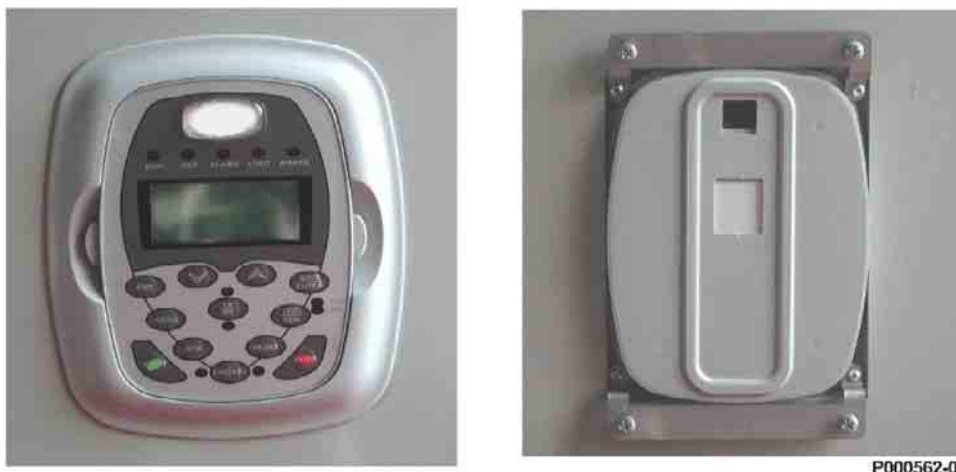
Рис. 66: Вид пульта управления и его оболочки.
