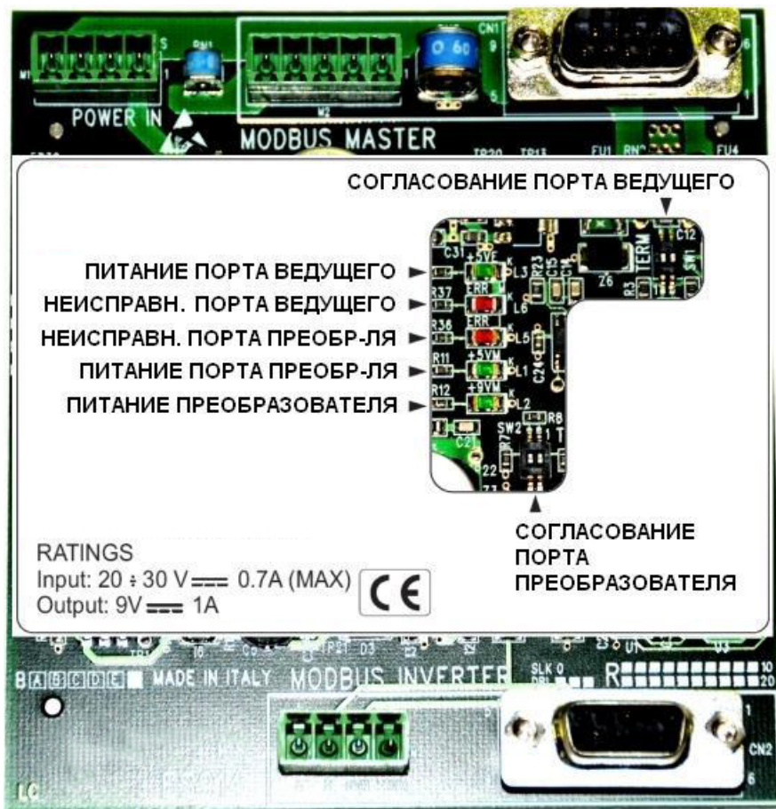
Рис. 173: Положение светодиодов и DIP-переключателей на плате ES914
