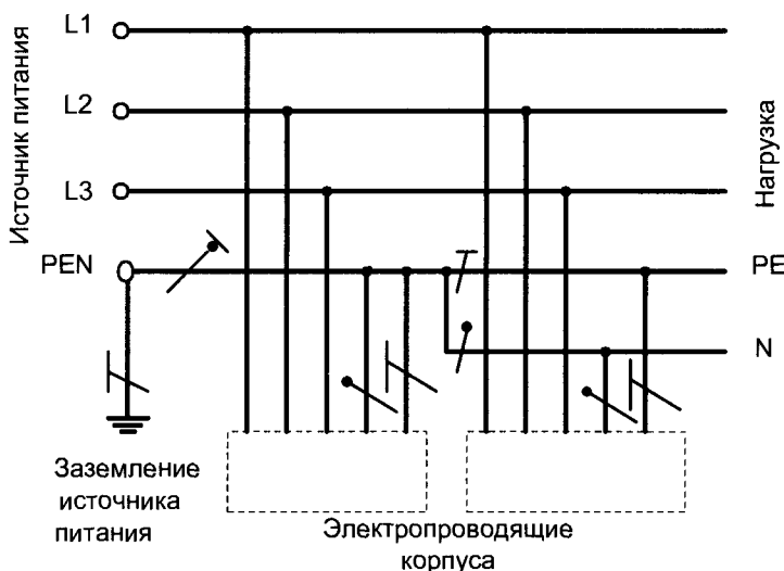
Рис. 6.5. Система TN-C-S (в части сети нулевой рабочий и нулевой защитный проводники объединены)
