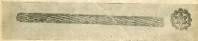
Рис. 2-1. Провод неизолированный алюминиевый марки А.
