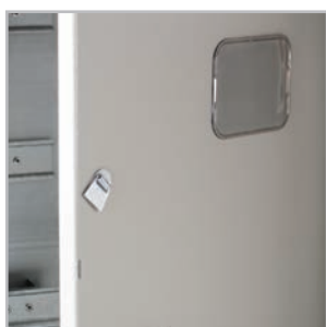
Оперативная панель имеет окно для снятия показаний электросчетчика и прорезь для доступа к аппарату защиты и крепится к корпусу при помощи петель и запирается индивидуальным замком-защелкой.
