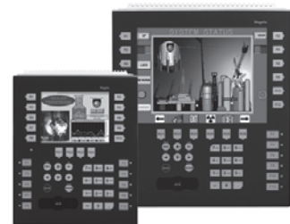
Функция ЧМИ: графические терминалы Magelis XBT GT/GK + Функция управления: ведущий модуль CANopen XBT ZG CANM
