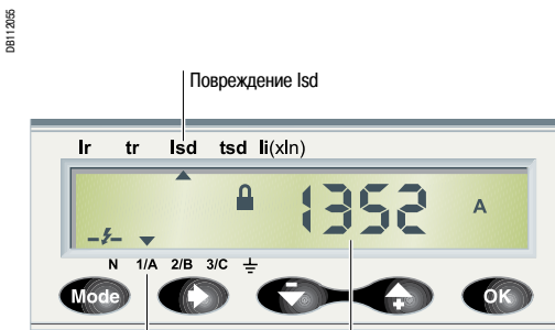
Индикация тока повреждения
