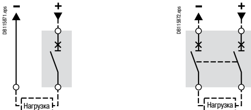
Выбор 1: стационарный 1-полюсный аппарат Compact NSX160N DC
