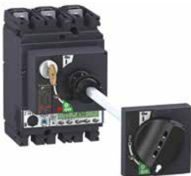
Сотракт NSX с выносной поворотной рукояткой. На лицевой панели установленного в глубине щита аппарата — дополнительный встроенный замок с ключом
