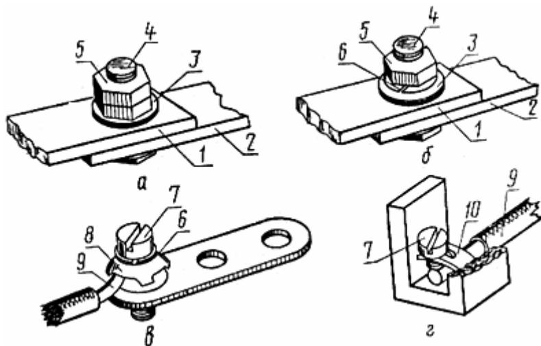
а - с контргайкой; б - с пружинной шайбой;
