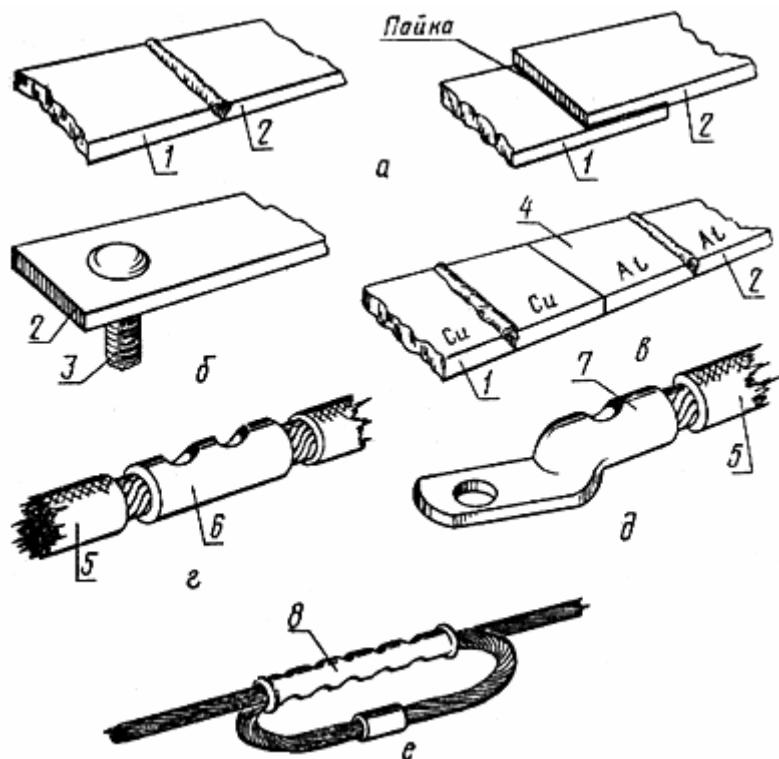
а - сваркой или пайкой; б - со штыревым выводом сваркой; в - сваркой через переходную медно-алюминиевую пластину; г - соединение жил проводов (кабелей) через соединительную гильзу опрессовкой; д - соединение жилы провода (кабеля) с кабельным наконечником опрессовкой (сваркой, пайкой); е - соединение жил проводов в овальных соединителях.
