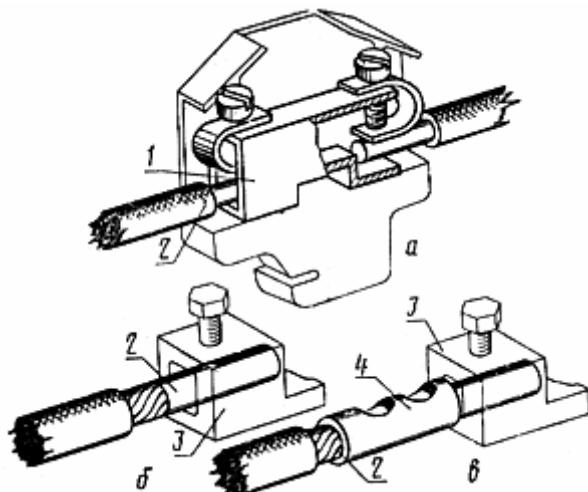
а, б - однопроволочная (многопроволочная, сплавленная в монолит) жила;
