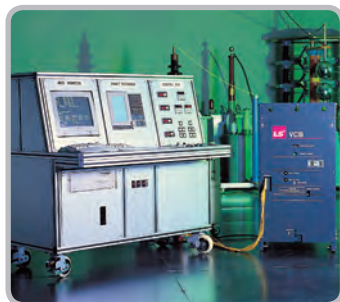
Проверка характеристик вакуумного автоматического выключателя
