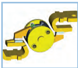
Оптимизированная форма эксцентрика
