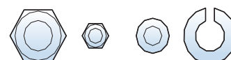
Гайка M5: 4 шт., Гайка M10, шайба стопорная, шайба плоская для 3-полюсного - 12 шт., для 4-полюсного - 16 шт.
