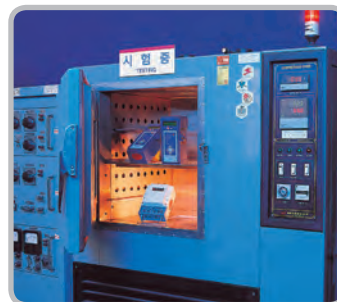
Испытание непрерывным воздействием высокой температуры
