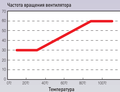
Контроль частоты вращения вентилятора в зависимости от температуры
