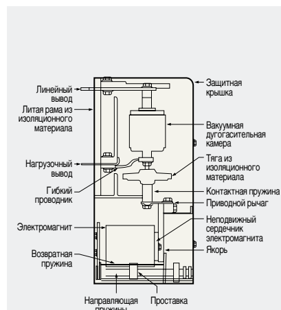
Главный контактный механизм
