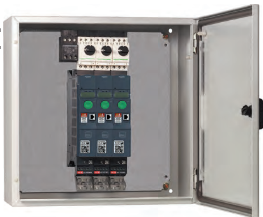
Пример прямого крепления автоматических выключателей GV2 к преобразователям частоты ATV320 в шкафу: автоматические выключатели GV2 L + принадлежности GV2 454 и GV2 G05 + преобразователи частоты ATV320U15N4B
