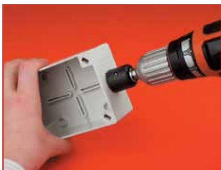
1 этап. Сверлим отверстия необходимого диаметра
