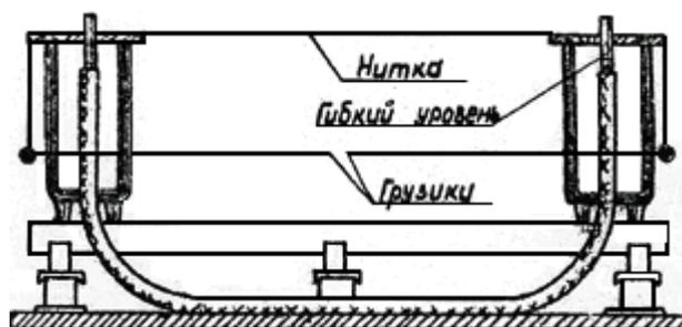
Рис.9. Установка крайних сосудов
