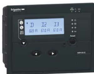
Рис. В24. Реле с автономным питанием VIP 400 с обратозависимой характеристикой выдержки времени, с защитой от сверхтоков и замыкания на землю (Schneider Electric)
