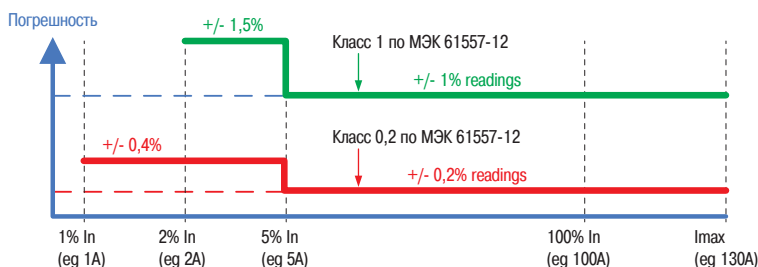
Рис. S10. Пределы погрешности для активной энергии при коэффициенте мощности = 1
