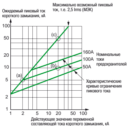
Рис. Н13. Зависимость ограниченного пикового тока от ожидаемых действующих значений переменной составляющей тока короткого замыкания для низковольтных плавких предохранителей
