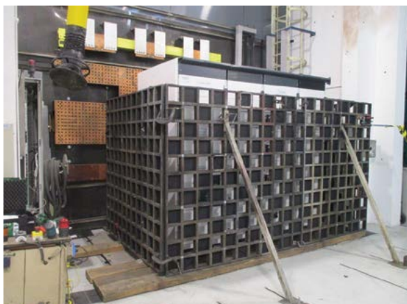
Рис. E39. Пример сборки с «индикаторами» (видны спереди и сбоку), подготовленной для проведения испытаний на внутреннюю дугу (Okken, Schneider Electric)
