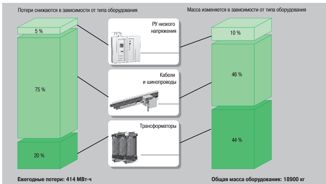
Рис. D28. Пример снижения потерь и изменения массы в зависимости от типа оборудования
