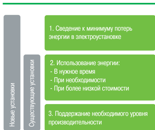
Рис. K4a. Реализация принципа энергоэффективности в соответствии со стандартом МЭК 60364-8-1
