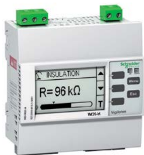
Рис. F20. Использование устройства контроля изоляции между фазами и землей обязательно для системы IT
