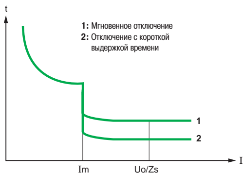
Рис. F18. Отключение системы TN автоматическим выключателем
