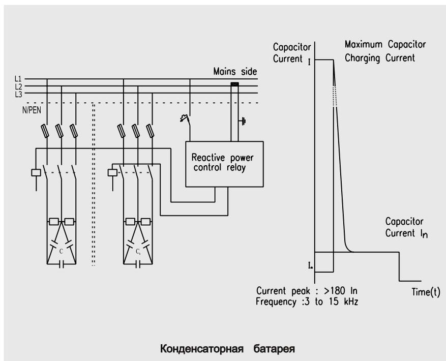
Такой значительный пусковой ток возникающий в паре контактор и конденсатор проходя через обычный контактор может повредить его («сварка» контактов), а также вывести из строя другое оборудование
