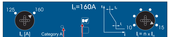
Внутренняя кнопка на расцепителе максимального тока
