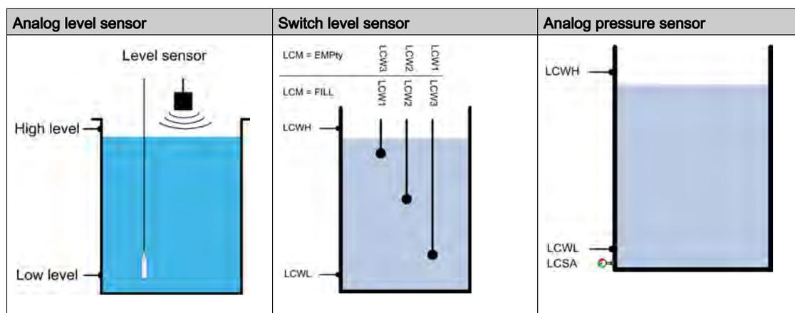
Коэффициент произвольного уровня [Коэф.случ.рег.ур] L C r X может быть назначен, чтобы уменьшить образование комков в баке. Значение 0% отключает функцию. Пусковой уровень для запуска первого насоса и уровень остановки для отключения последнего насоса прикладывается с учетом случайного смещения на основе +/- [Коэф.случ.рег.ур] L C r X %.
