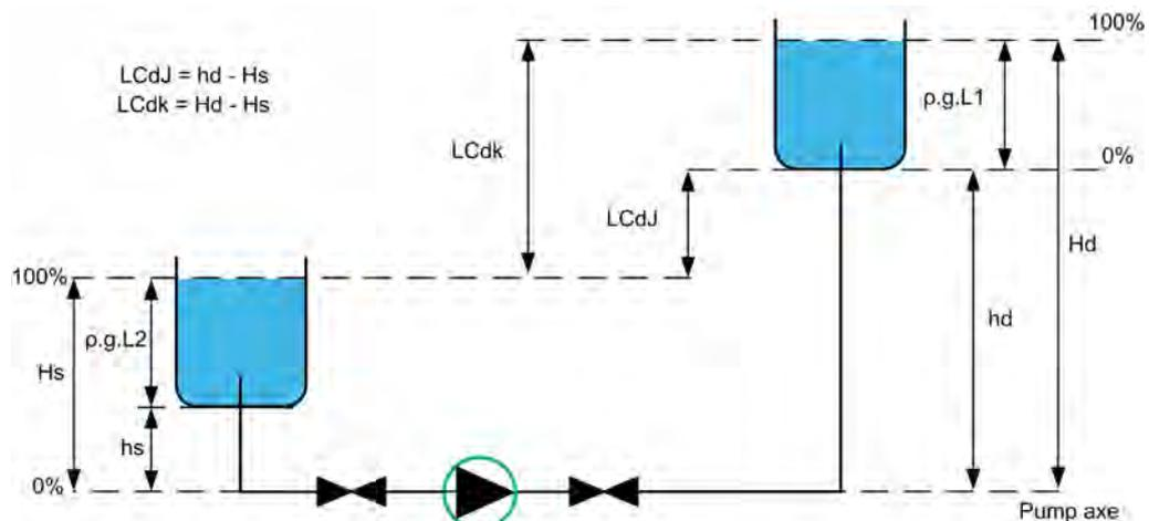
hd Высота разгрузки, когда резервуар назначения пуст
