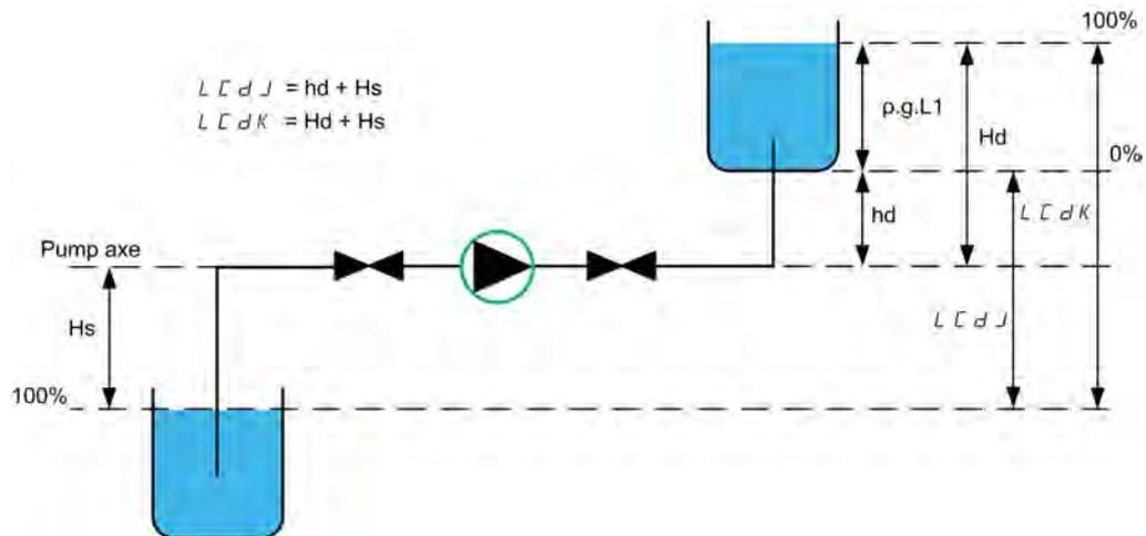
hd Высота разгрузки, когда резервуар назначения пуст.
