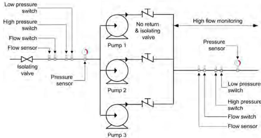
Данная функция контролирует расход на выходе станции:
