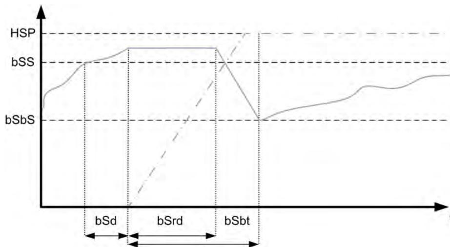
При поступлении запроса на отключение дополнительного насоса после паузы [НС пауза отключ.] 5 d r d скорость регулируемого с помощью ПЧ основного НА увеличивается до значения [НС Байп.ск.откл.] 5 d b 5 в течение времени [НС байп.вр.откл.] 5 d b t.
