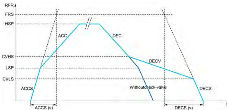
При запуске насос разгоняется до **[Нижней скорости] L 5 P** в соответствии с параметром **[Вр. разг. при пуске] A C C 5**. Когда частота вращения насоса больше **[Нижней скорости] L 5 P**, то времена разгона и торможения управляются в соответствии с параметрами **[Время разгона] A C C** и **[Время торможения] d E C**, если не активизирована другая функция.
