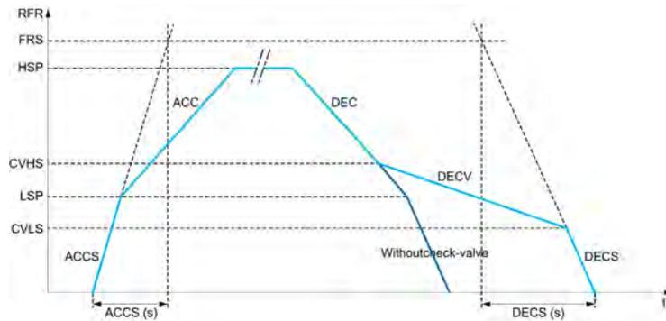
При запуске насос разгоняется до **[Нижней скорости] LSP** в соответствии с параметром **[Вр. разг. при пуске] ACCS**. Когда частота вращения насоса больше **[Нижней скорости] LSP**, то времена разгона и торможения управляются в соответствии с параметрами **[Время разгона] ACC** и **[Время торможения] DEC**, если не активизирована другая функция.
