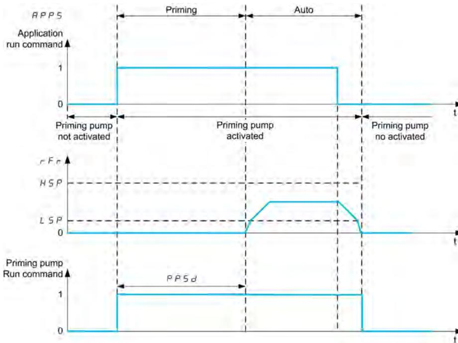
Если функция насоса заливки активна и условия для запуска основного насоса выполнены, то заливочный насос сразу же включается, в то время как ведущий насос будет запущен при выполнении одного из заданных условий:
