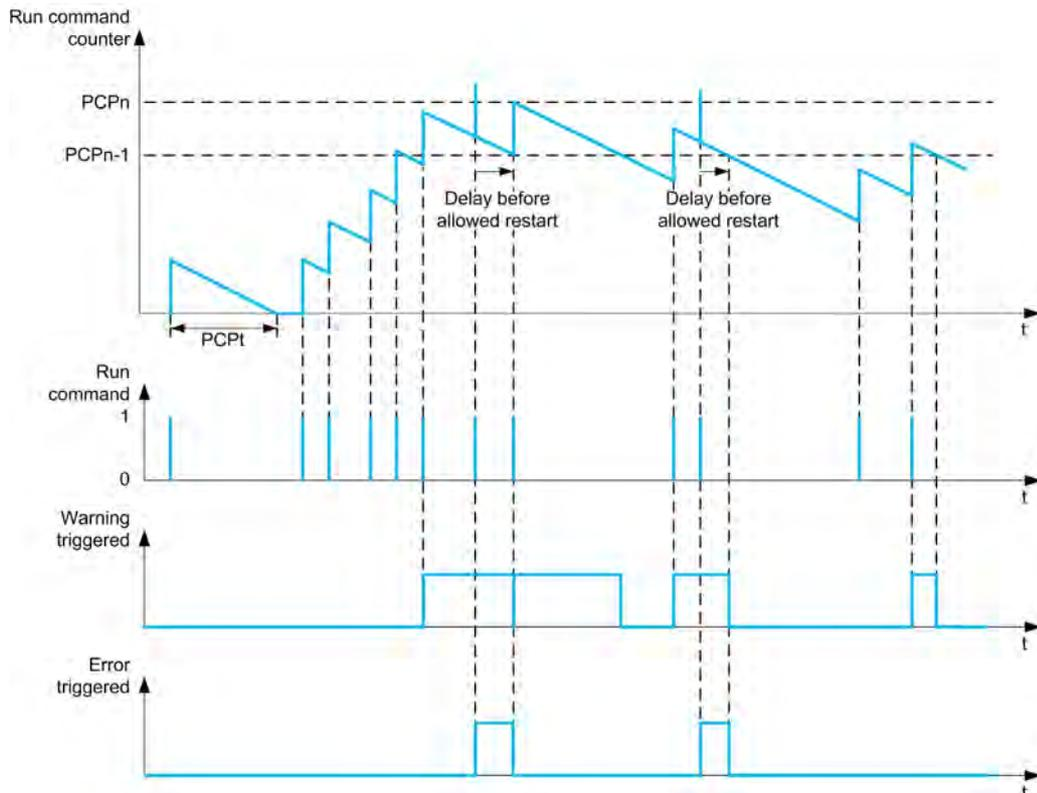
Если [Контроль цикл. насоса] PCPP настроен на [Режим 1] norP, то функция активизируется без управления задержкой отключения питания.
