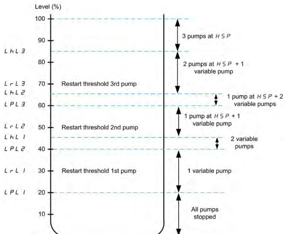
Пример описания циклограммы для процесса слива резервуара с тремя насосными агрегатами:
