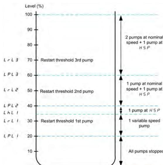
Пример описания циклограммы для процесса слива резервуара с тремя насосными агрегатами:
