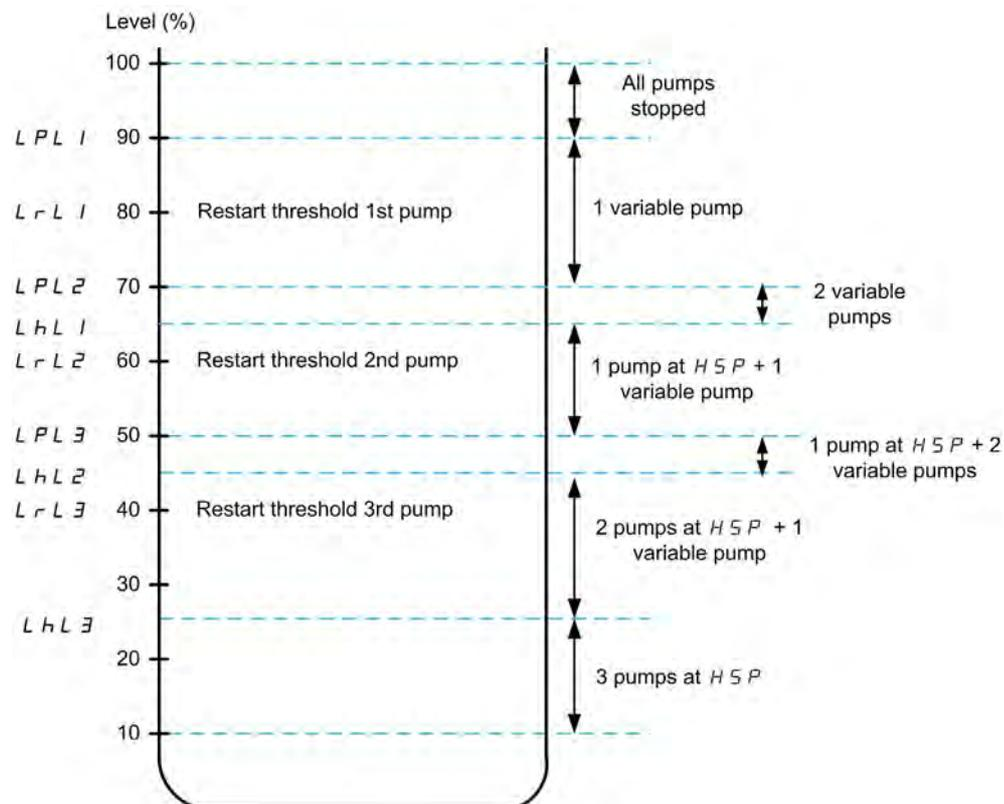
Опорожнение - три насосных агрегата
