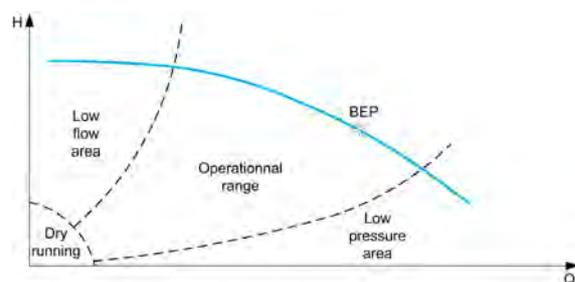
Эта функция помогает обнаружить возможную ситуацию, связанную с отсутствием или низким расходом, различными способами:
