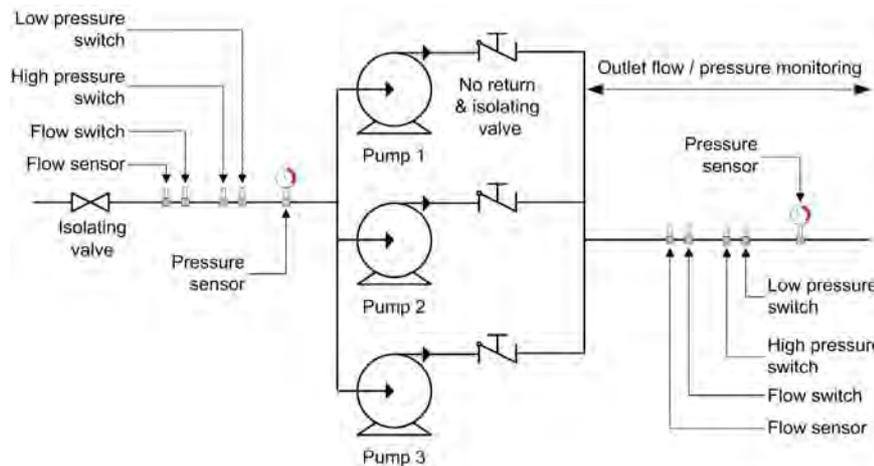
Функция режима контроля давления на выходе обеспечивает фиксацию следующих состояний напорной магистрали:
