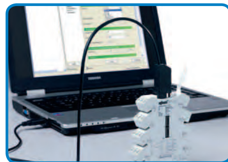
Конфигурирование переключателей с абонентским кабелем WAGO-USB 750-923
