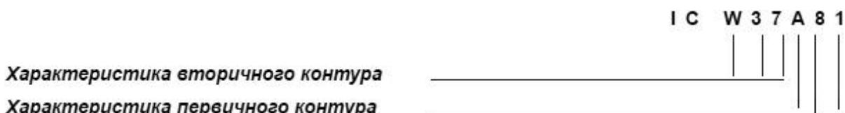
В этом издании стандарта предусмотрено по возможности упрощенное обозначение путем пропуска в обозначении буквы А и цифры 7 при определенных условиях перемещения вторичного хладагента.
