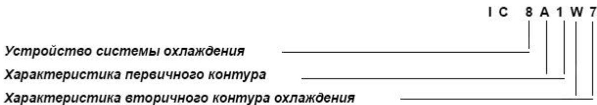
В предшествующем издании настоящего стандарта применялась другая система обозначений. Сначала приводилась характеристика вторичного контура, а затем - первичного. Каждый контур обозначался буквой (тип хладагента) и цифрой (устройство контура охлаждения). Затем следовала вторая цифра (способ перемещения хладагента).
