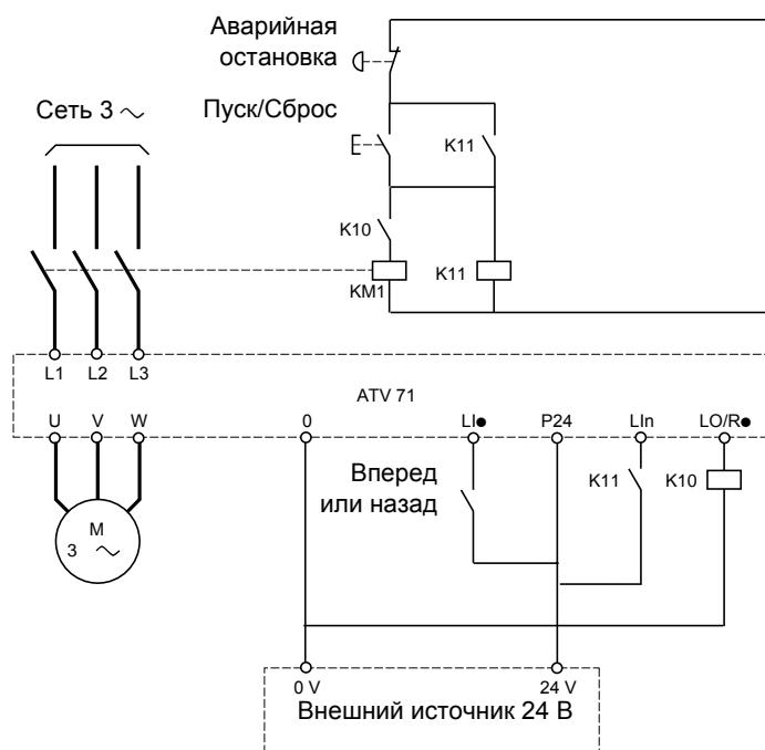
**Примечание:** после нажатия кнопки Аварийная остановка необходимо нажать на клавишу Пуск/Сброс.
