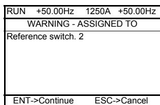
Если уровень доступа обеспечивает новое назначение, то нажатие на клавишу ENT подтверждает назначение.
