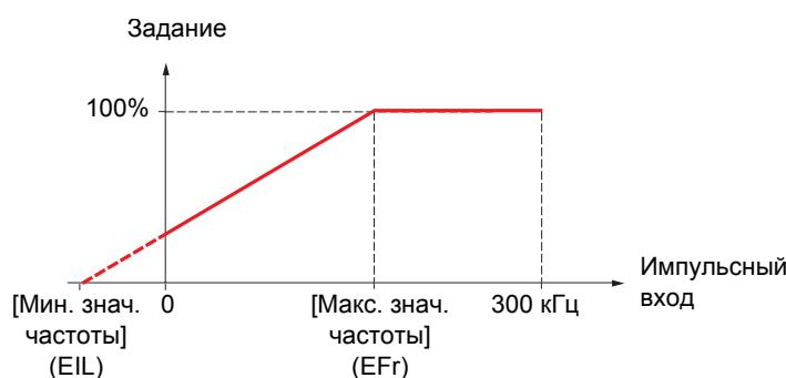
Назначение отрицательного значения для минимальной величины позволяет получить задающий сигнал при нулевой частоте.
