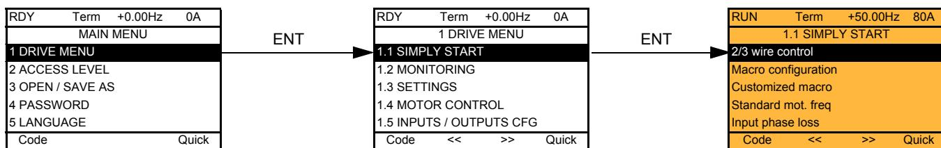
ПЧ со встроенным терминалом:
