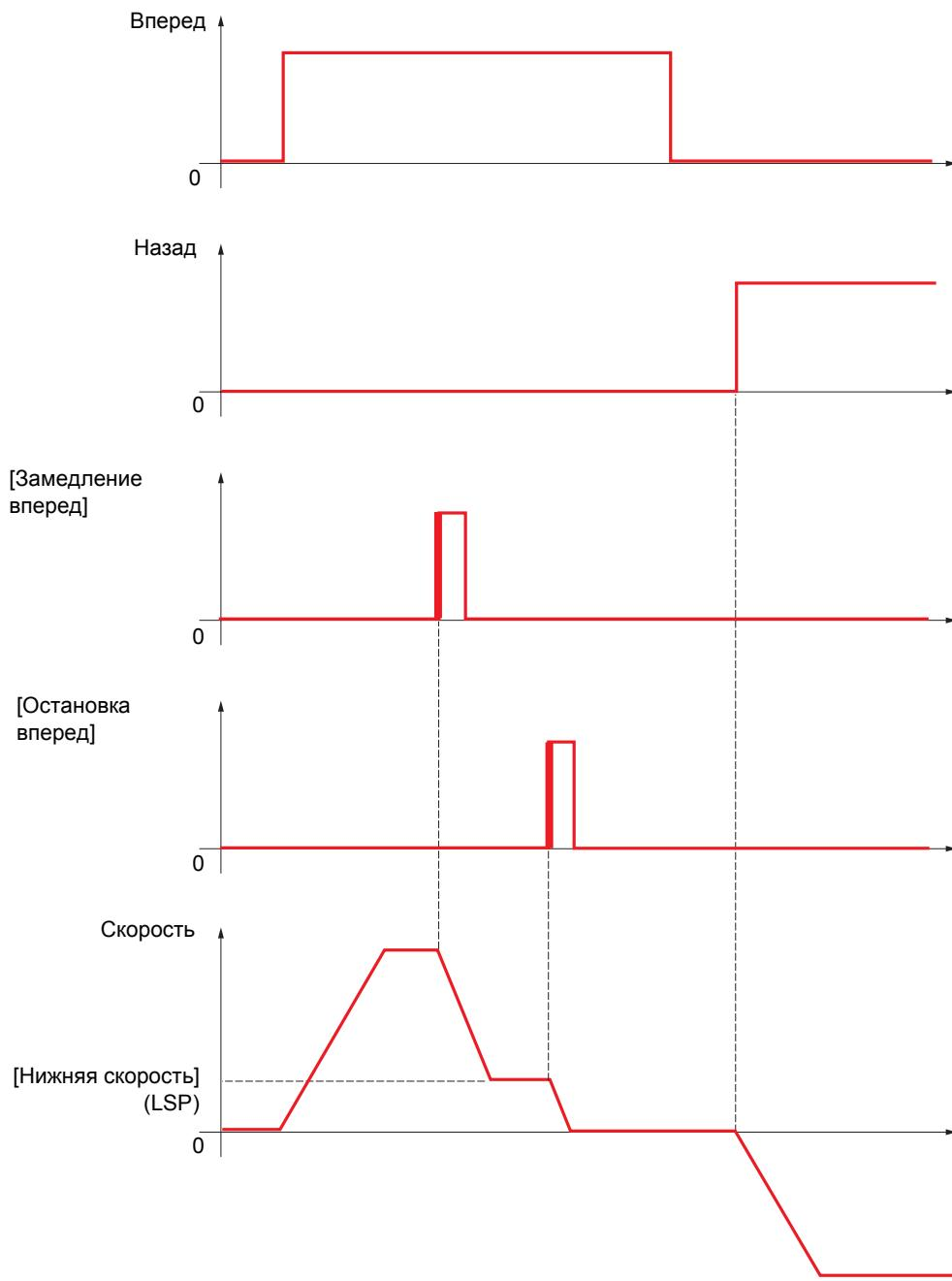
Режим замедления и Тип остановки конфигурируются. Принцип работы идентичен для обоих направлений вращения. Замедление и остановка осуществляются в соответствии с одинаковой логикой, приведенной ниже.
