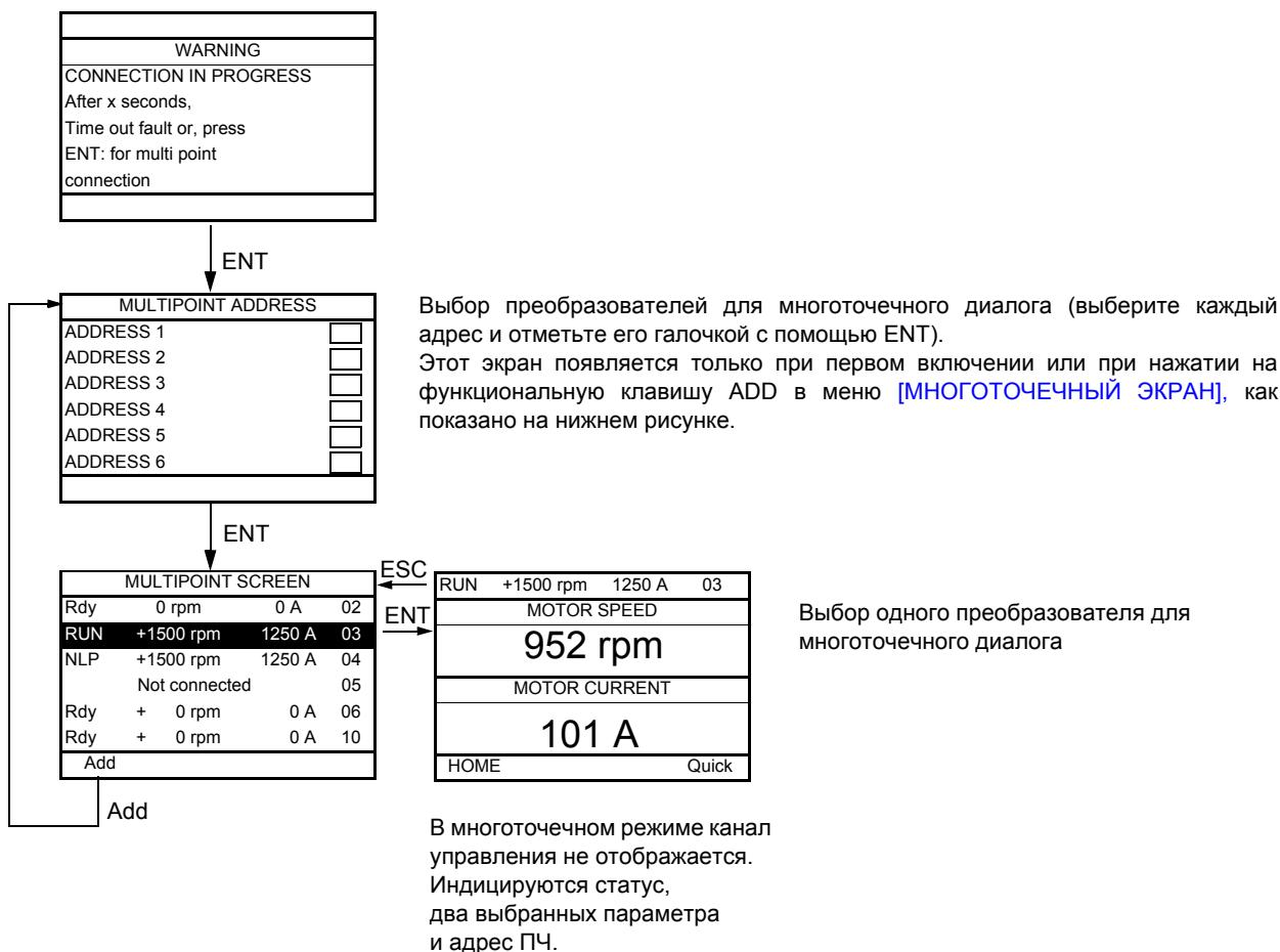
**В многоточечном режиме возможен доступ ко всем меню. Однако управление преобразователями с графического терминала невозможно, за исключением клавиши Stop, которая блокирует все ПЧ.**
