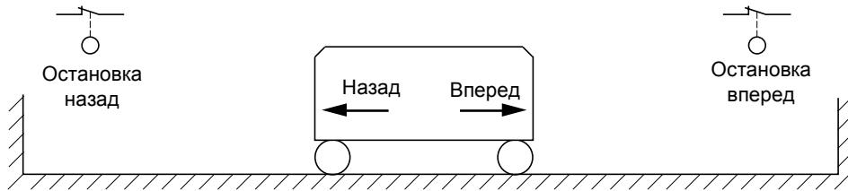
Остановка имеет место при нулевом состоянии входа (открытый контакт).
