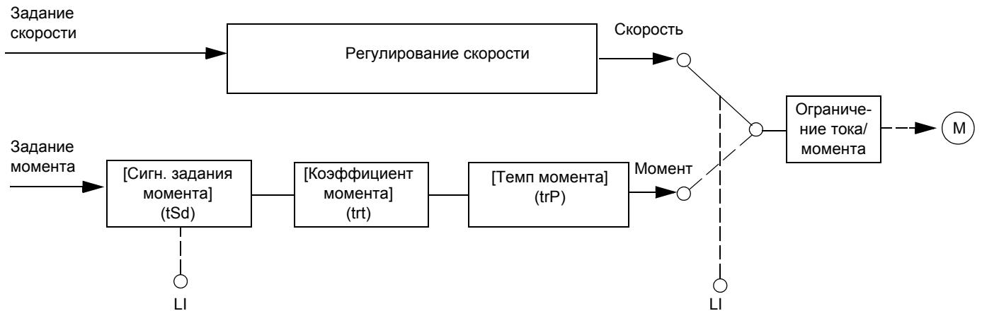
Функция обеспечивает переключение режимов работы при регулировании скорости или управлении моментом.
