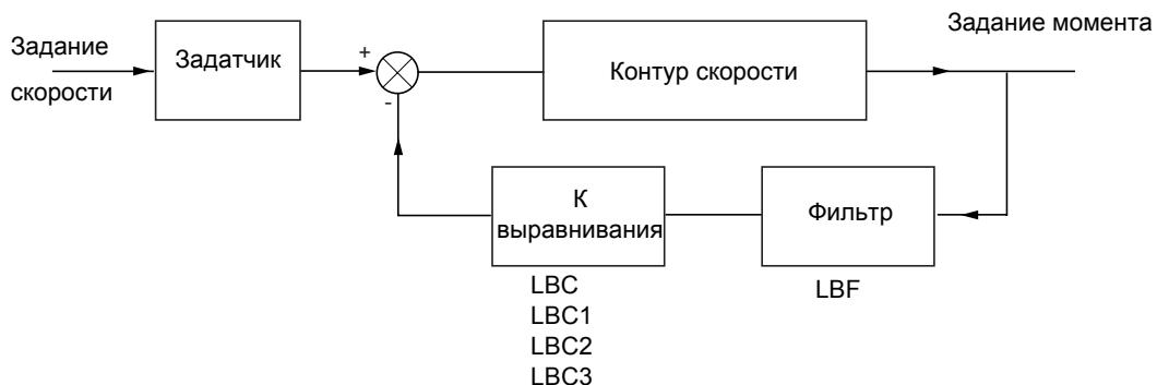
Коэффициент выравнивания нагрузки К зависит от скорости и момента и определяется двумя коэффициентами K1 и K2 ( $K = K1 \times K2$ ).
