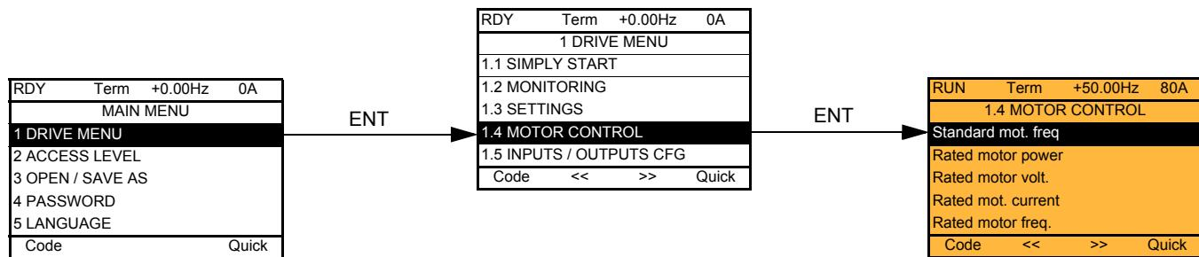
Со встроенным терминалом:
