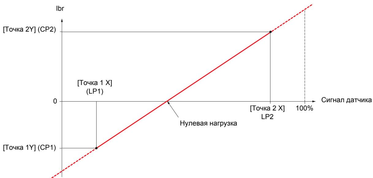
Характеристика может соответствовать случаю взвешивания лифтовой кабины, когда приведенная к валу двигателя нагрузка равна нулю, в то время как сама кабина загружена (неуравновешенная кабина).
