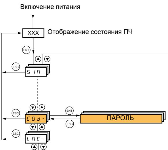
Позволяет защитить конфигурацию с помощью кода доступа или ввести пароль для доступа в защищенную конфигурацию.
