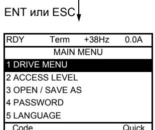
При отсутствии выбора автоматический переход через 10 с к меню "Мониторинг" (индикация в соответствии с выбранной конфигурацией)
