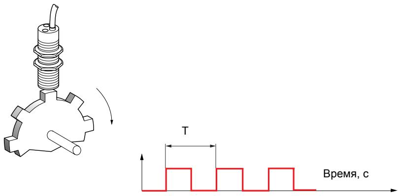
Этот сигнал, приложенный к импульсному входу, обеспечивает следующие возможности:
