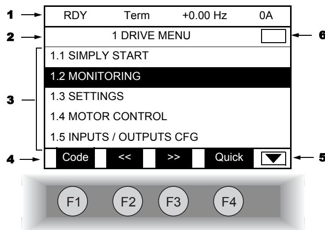
1. Стока индикации: ее содержание конфигурируется; при заводской настройке на ней отображаются:
