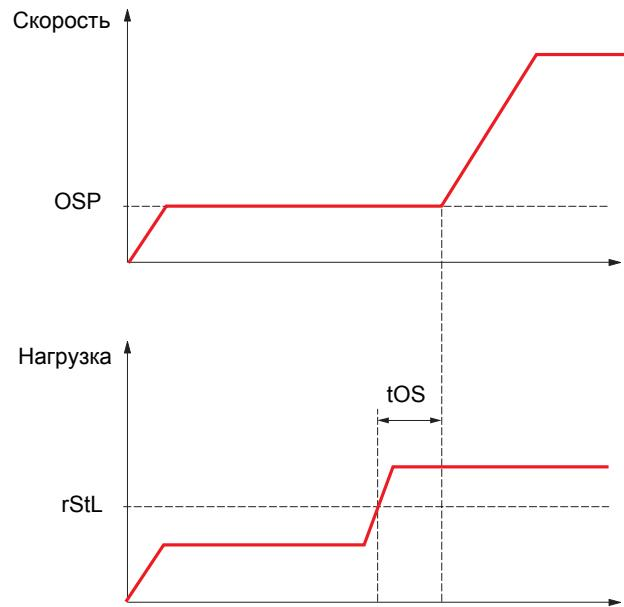
Для измерения нагрузки используется скачок скорости (параметр OSP), описанный на стр. [165](#). До тех пор, пока нагрузка не достигнет настраиваемой уставки, соответствующей весу крюка, рабочий цикл измерения (параметры OSP и tOS) не будет запущен.
