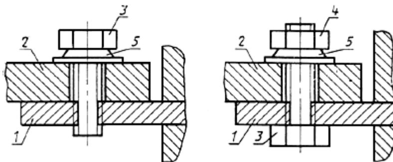
1 - плоский вывод; 2 - кабельный наконечник; 3 - болт; 4 - гайка; 5 - устройство, предохраняющее крепежные детали от самоотвинчивания (тарельчатая пружина, пружинная шайба и т.п.).
