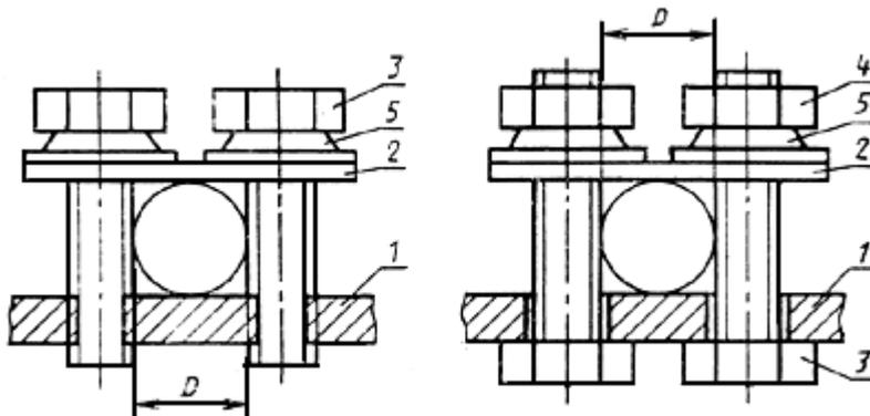
1 - плоский вывод; 2 - планка; 3 - болт; 4 - гайка; 5 - устройство, предохраняющее крепежные детали от самоотвинчивания (тарельчатая пружина, пружинная шайба и т.п.).
