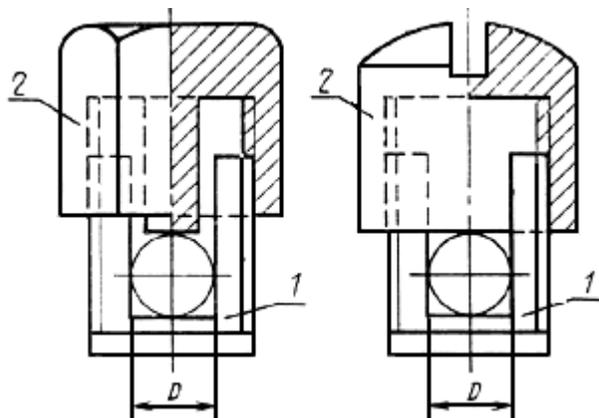
1 - гнездовой вывод; 2 - колпачковая гайка.
