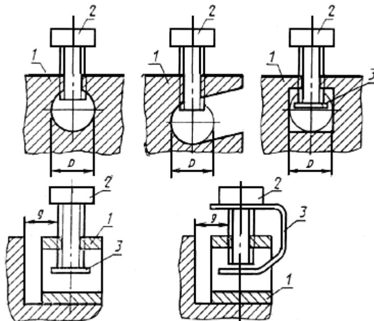
1 - гнездовой вывод; 2 - винт; 3 - устройство, предохраняющее крепежные детали от самоотвинчивания
