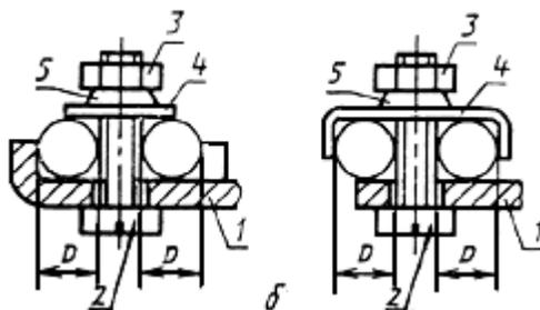
1 - плоский вывод; 2 - винт; 3 - гайка; 4 - фасонная шайба; 5 - устройство, предохраняющее крепежные детали от самоотвинчивания (тарельчатая пружина, пружинная шайба).
