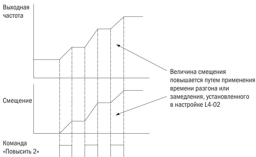
Рис. 6.20. Повышение 2 / понижение 2 смещения при  $L4-01 = 0,0 \text{ Гц}$
