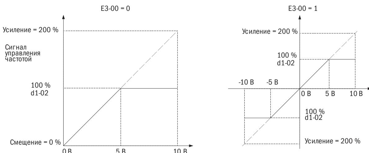
Рис. 6.41. Сигнал управления частотой, отрегулированный усилением и смещением
