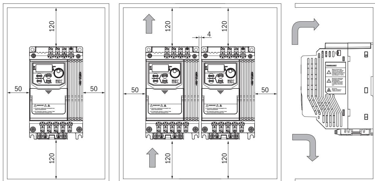
Рис. 3.2. Установка преобразователей
