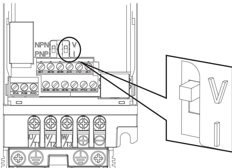
Рис. 4.4.2. DIP-переключатель А1
