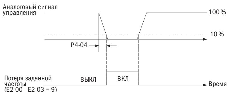
Рис. 6.53. Работа по обнаружению потери заданной частоты
