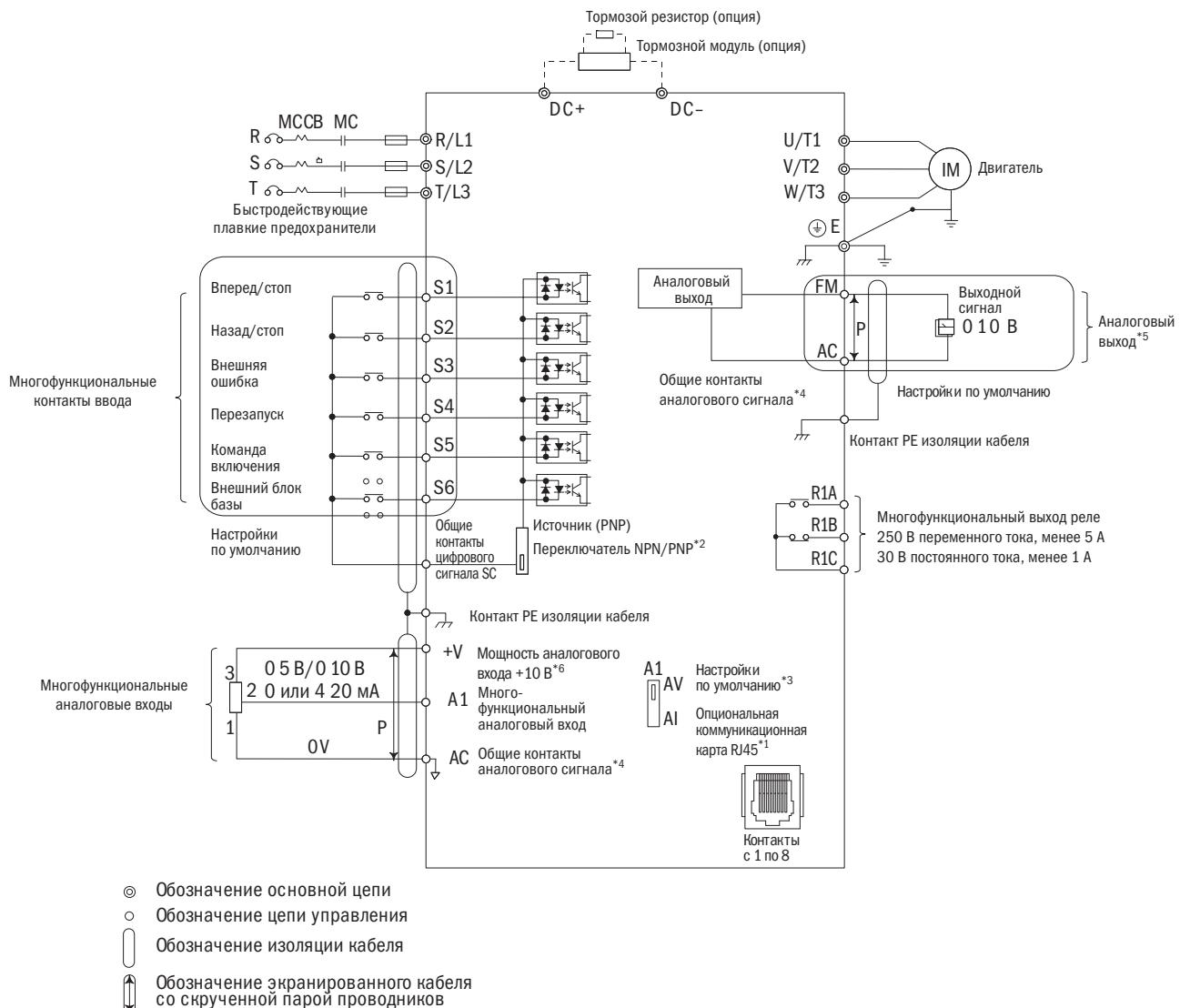
\*<sup>1</sup> Порт RJ45 можно подключать к встроенной линии связи RS-485 или опциональным коммуникационным картам (находятся в процессе разработки).
