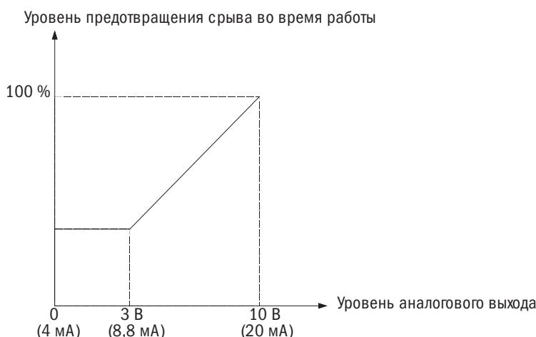
Рис. 6.45. Уровень предотвращения опрокидывания с использованием аналогового входа
