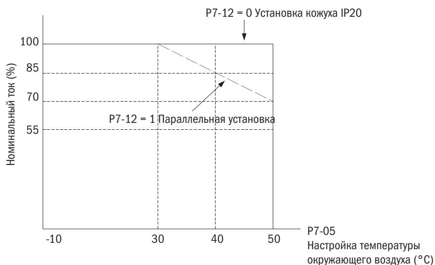
Рис. 10.1. Зависимость снижение номинального тока от температуры окружающей среды
