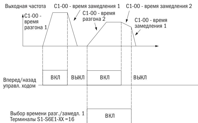
Рис. 6.13. Порядок изменения времени разгона/замедления посредством многофункционального входа
