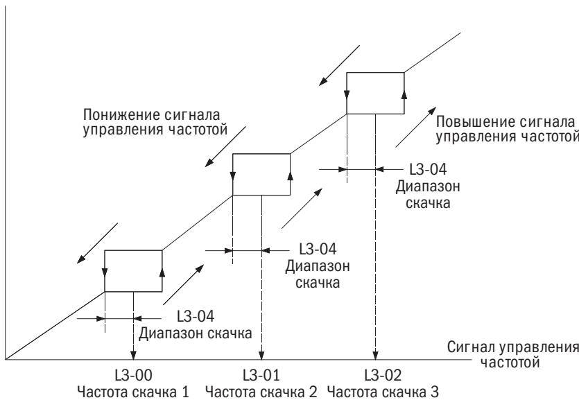
Рис. 6.18. Действие перескока частоты
