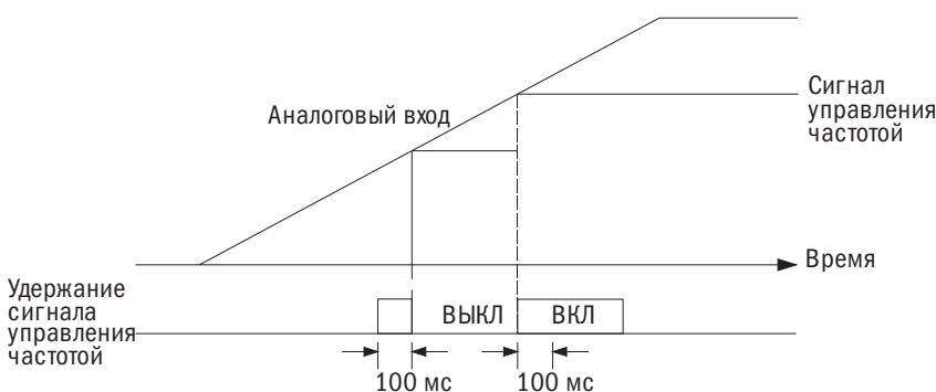
Рис. 6.32. Функция поддержания аналогового сигнала управления частотой
