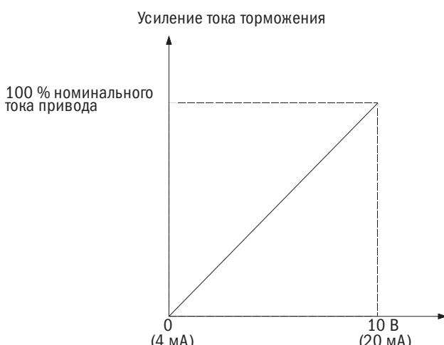
Рис. 6.44. Торможение постоянным током с использованием аналогового входа
