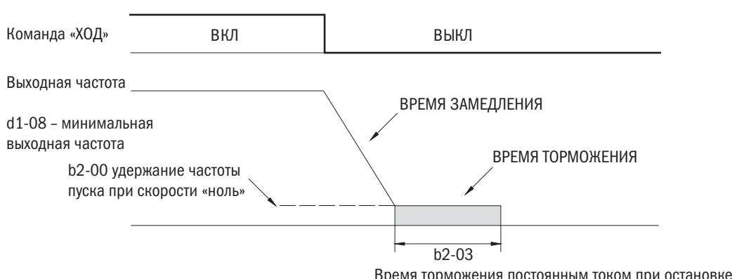
Рис. 6.3. Сигнал остановки
