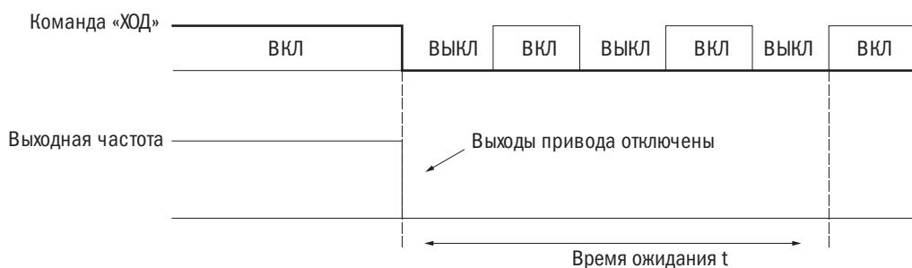
Рис. 6.8. Работа по инерции до остановки с таймером
