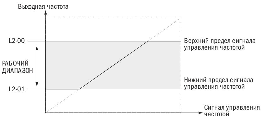
Рис. 6.17. Верхний и нижний пределы сигнала управления частотой
