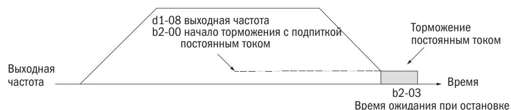
Рис. 6.9. Время торможения постоянным током при остановке
