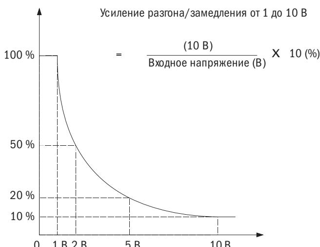
Рис. 6.43. Усиление времени разгона/замедления с использованием аналогового входа
