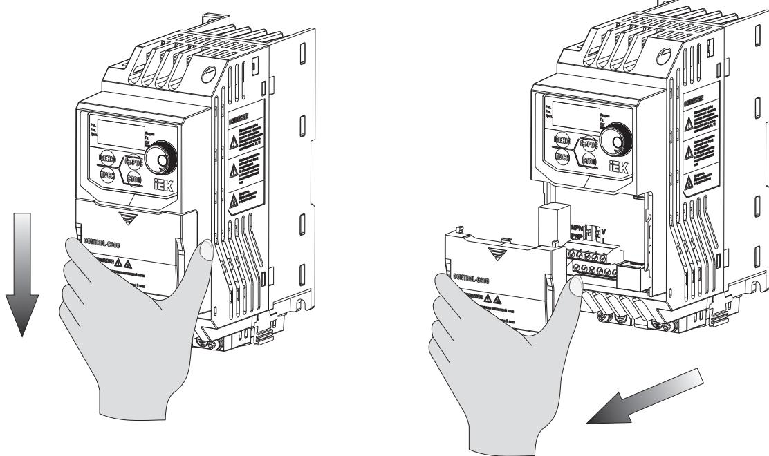
Шаг 1: сдвиньте крышку клеммной колодки вниз
