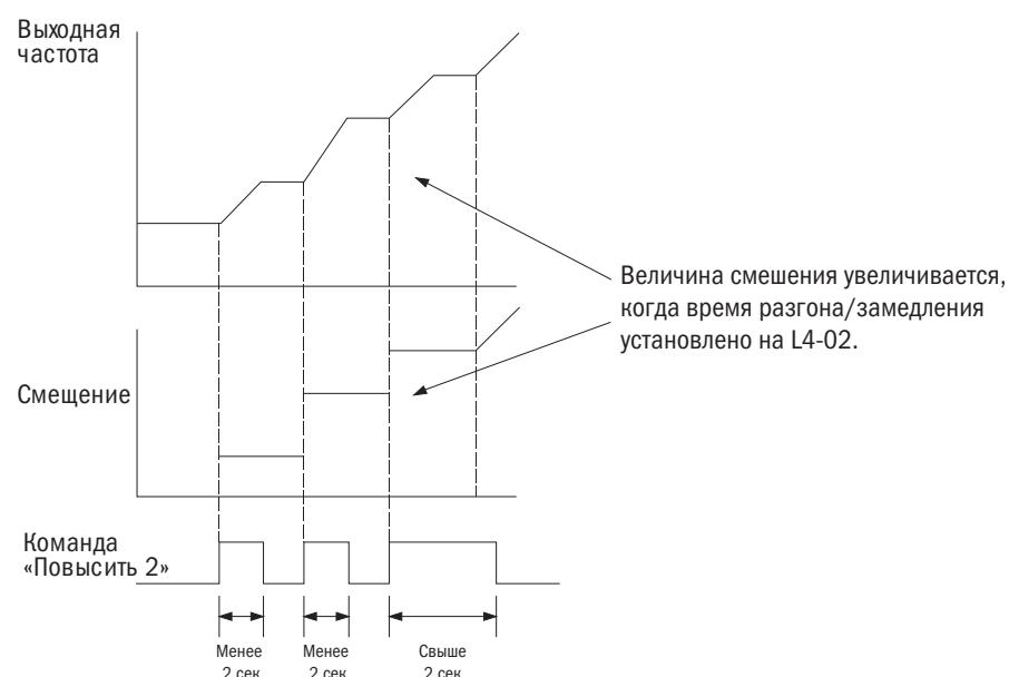
Рис. 6.21. Повышение 2 / понижение 2 смещения, если  $L4-01 > 0,0 \text{ Гц}$
