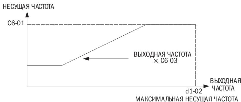
Рис. 6.14. Изменение несущей частоты на базе выходной частоты
