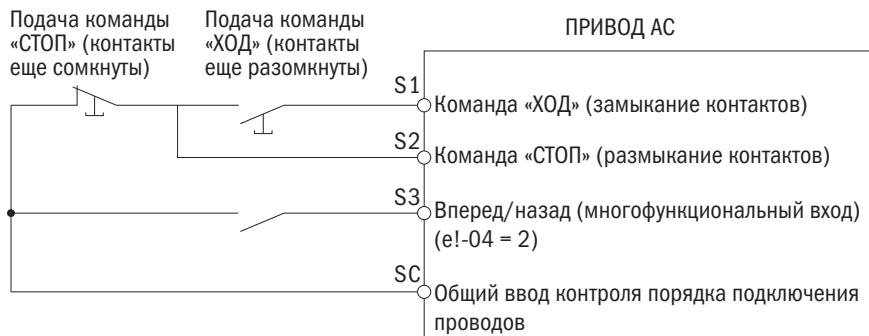
Рис. 6.26. Схема трехпроводного подключения управлением преобразователя
