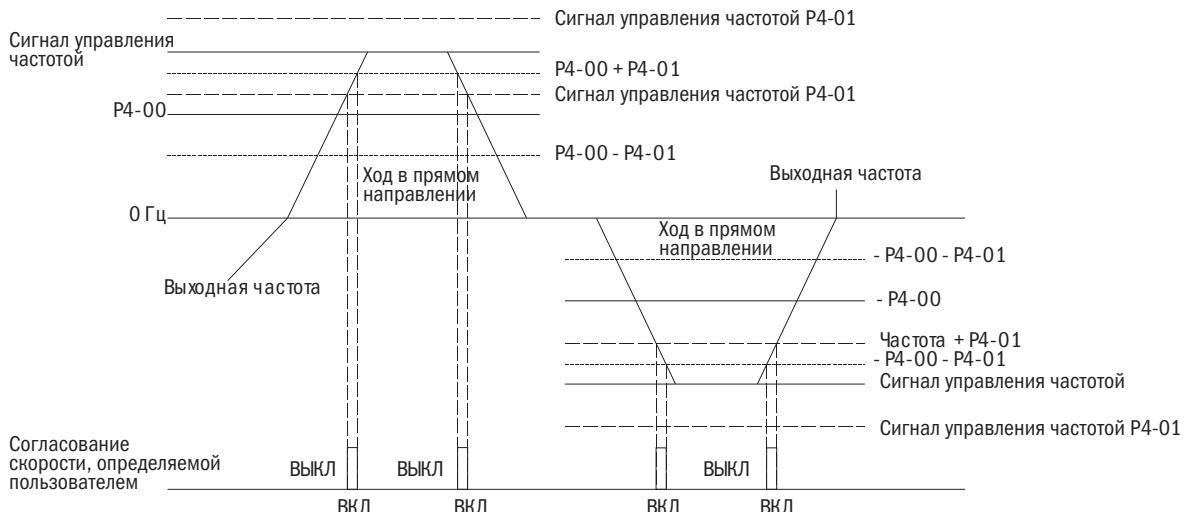
Рис. 6.36. Функция согласования определяемой пользователем частоты (скорости)
