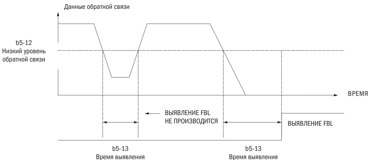
Рис. 6.11. Определение нижнего предела обратной связи ПИД
