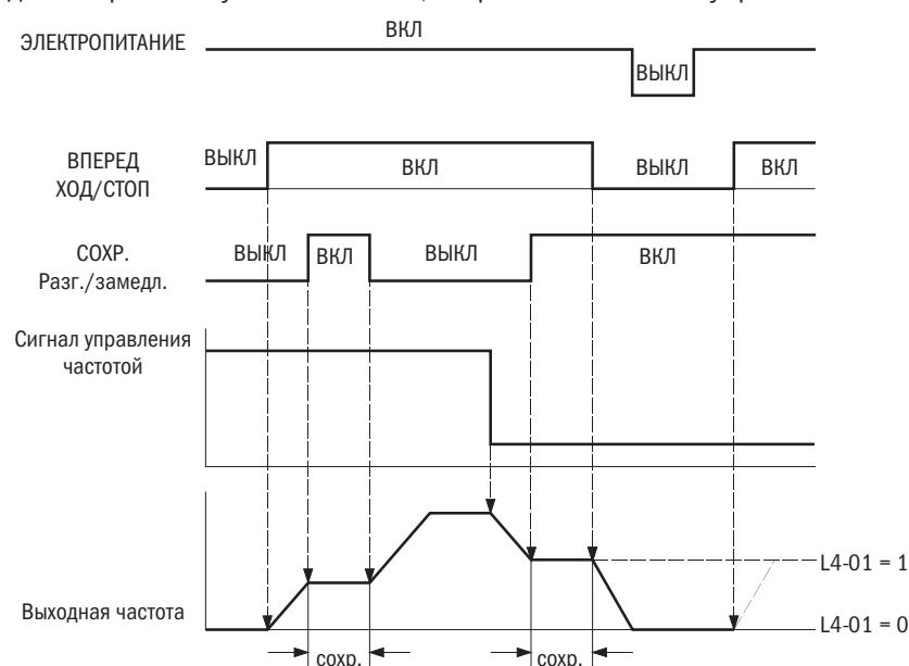
Рис. 6.40. Сохранение сигнала управления частотой вместе с разгоном/замедлением
