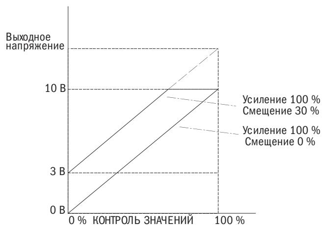
Рис. 6.46. Усиление аналогового выхода и действие напряжения смещения
