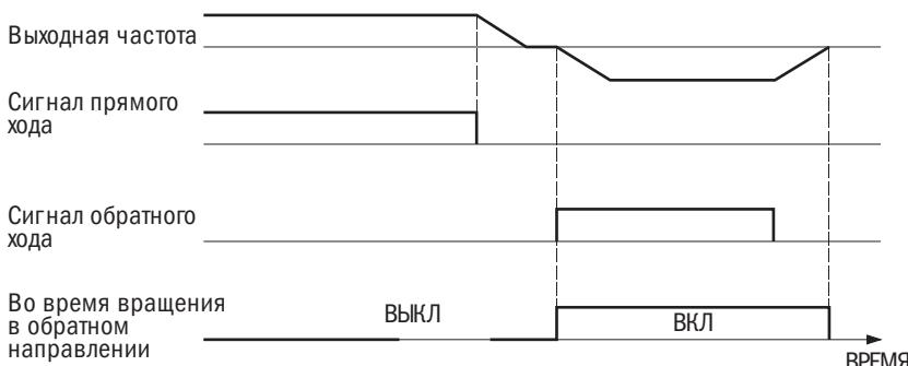
Рис. 6.39. В режиме вращения электродвигателя в обратном направлении
