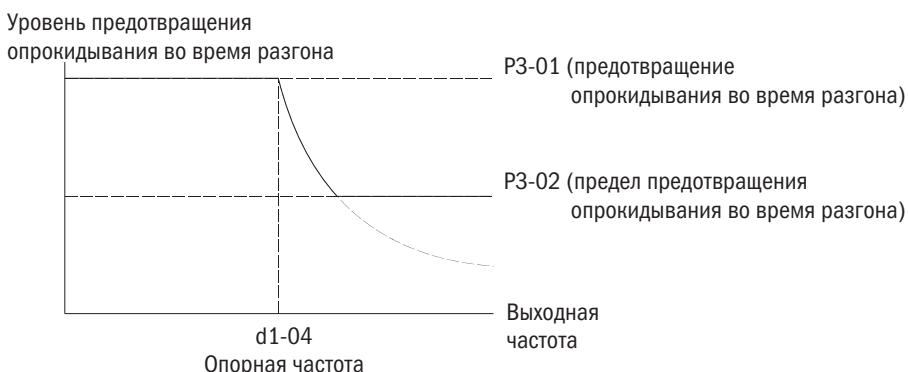
Рис. 6.50. Уровень предотвращения опрокидывания во время разгона
