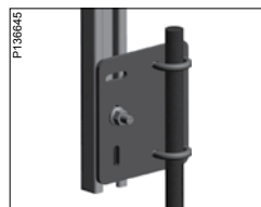
Арматурное крепление для пола крепится к Монтажному профилю 24/48 T-болтами 26F M10.
