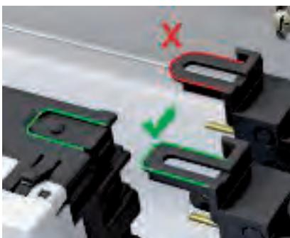
**Кодировка стороны подключения гнезда**
