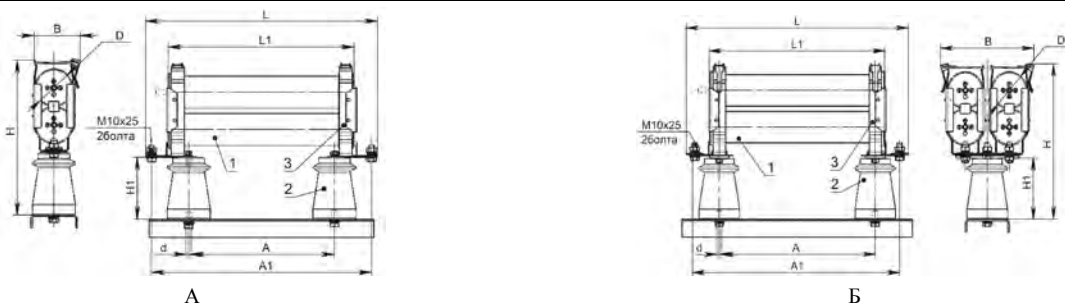
Рисунок 2. Габаритные и установочные размеры предохранителей ПКТ-103, ПКТ-104.
