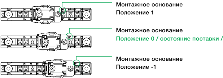
Монтажное основание Вид сверху
