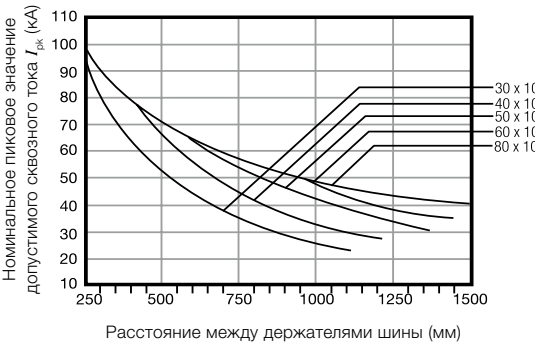
Диаграмма устойчивости к короткому замыканию Расстояние между центрами шин 100 мм
